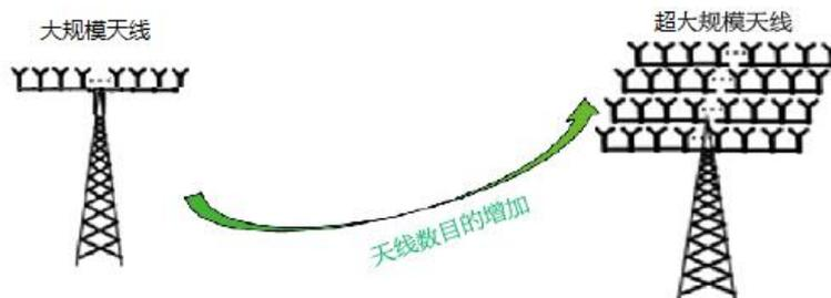
在多天线方面，MIMO 技术已经用于 4G 和 5G 网络，通过空分复用，大大提高吞吐量。随着频段升高电磁波波长也减小，同时天线和芯片的集成度不断提升，天线阵列规模将不断增加，可以产生宽度更小和能量更加集中的波束，以克
